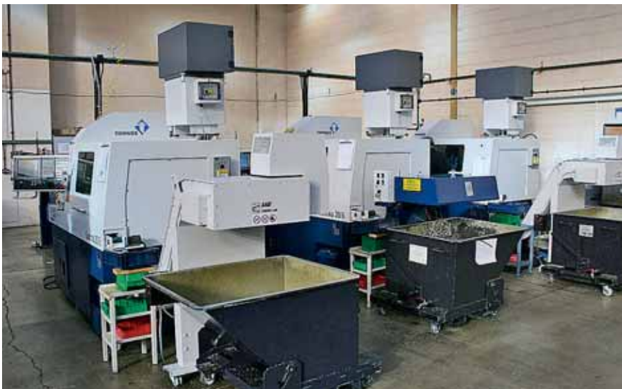
Tornos Gamma 20 in Reih und Glied bei Technoset.
