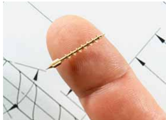
Diese ca. 1,5 cm lange hochpräzise Zerstäuberwelle aus Messing für eine Textilmaschine wurde kurz nach einer Serie von Inox-Teilen mit demselben Schneidöl (Ortho NF-X) auf einer Tornos Deco 2000 hergestellt.
