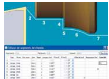
Possibilité d'ajouts manuels de mots ISO sur les géométries
