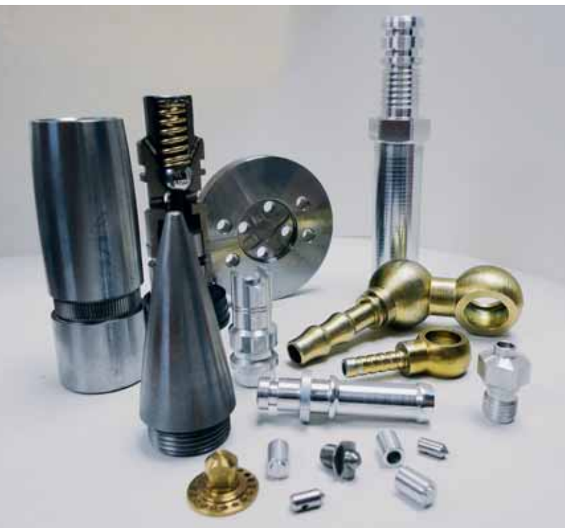
Quelques exemples de pièces usinées par Joarjo, y compris des vannes dessinées par l'entreprise.
